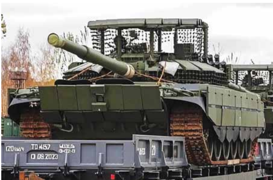
Nauji rusiški tankai T-72B3M2022 keliauja tiesiai iš gamyklos į frontą, ant jų stogelių – reaktyvinio šarvo elementai
